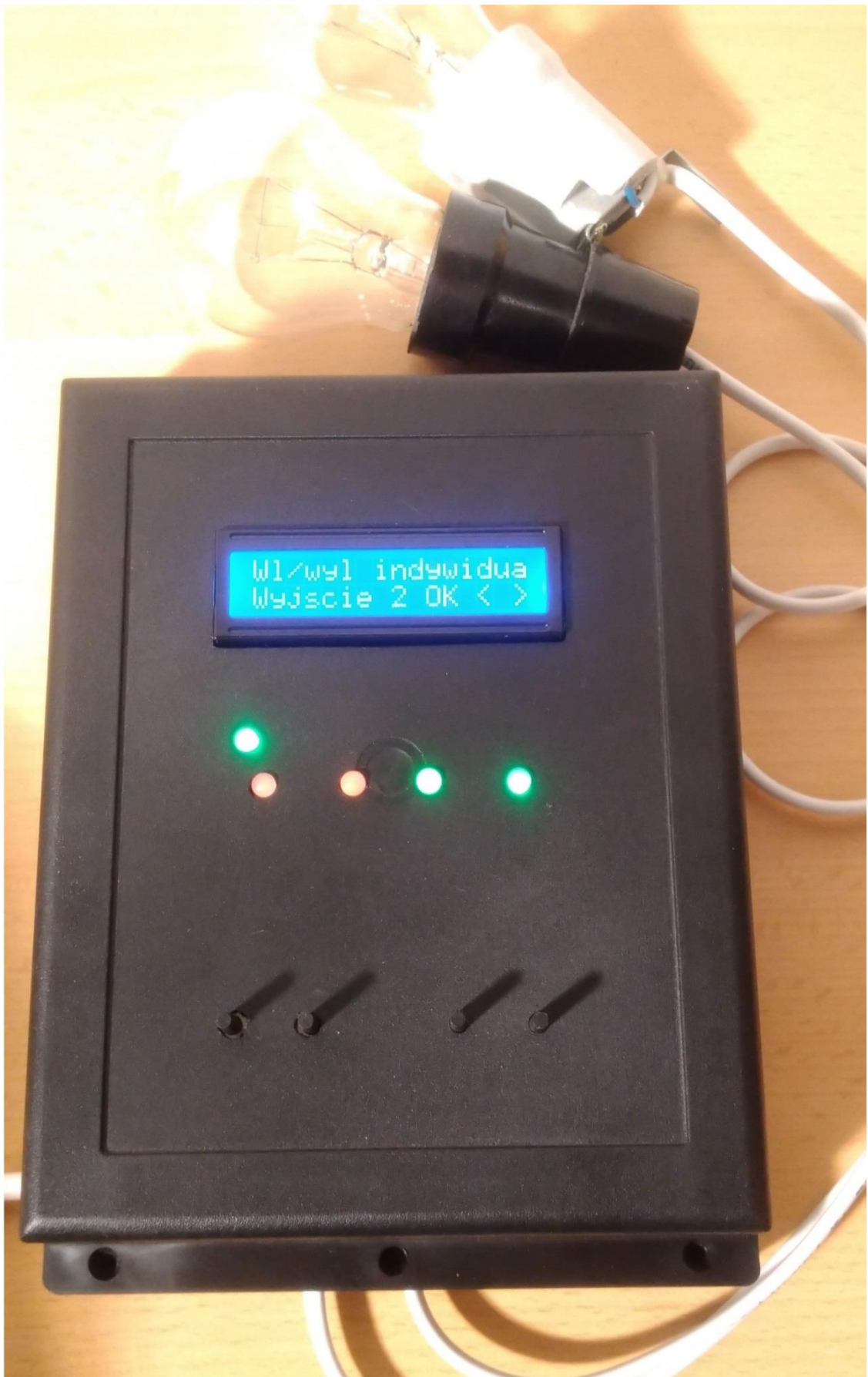
Rysunek 4.18. Zdjęcie przedstawiające dwa indywidualnie wyłączone kanały kontrolera przy użyciu menu LCD kontrolera
