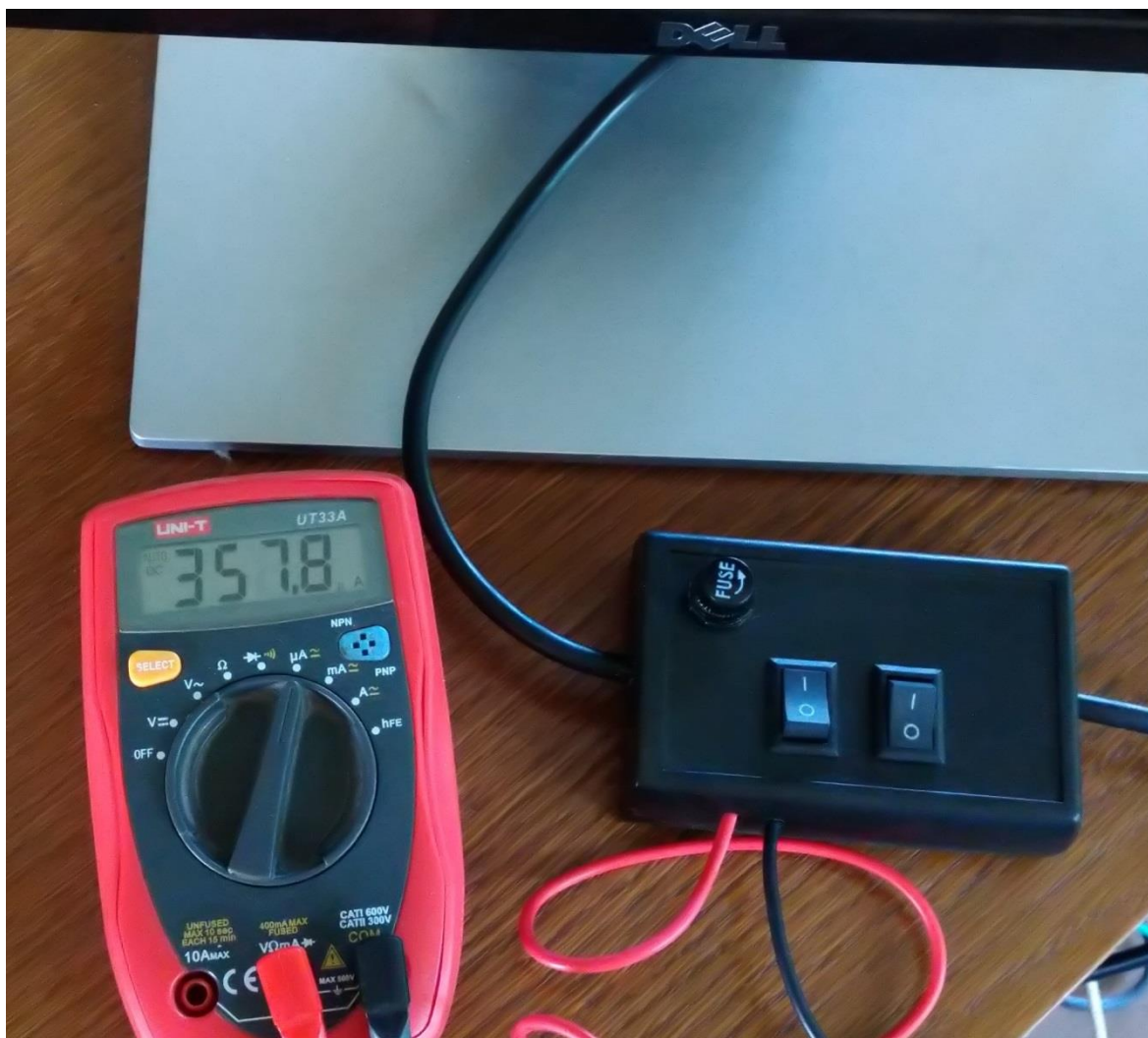
Rysunek 4.23. Zdjęcie przedstawiające dokonywanie pomiaru z użyciem przyrządu do pomiaru przepływu prądu urządzeń jednofazowych oraz miernika UNI-T UT33A wyświetlając wskazanie przepływu prądu w trybie czuwania na poziomie 357,8 \mu\text{A}
