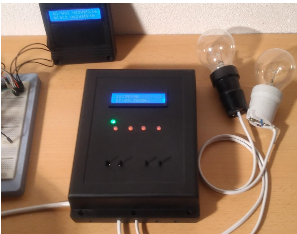
Rysunek 4.13. Zdjęcie przedstawiające działające oba urządzenia składające się na system poprawnie komunikujące się wraz z przykładowym obciążeniem wyjść kontrolera
