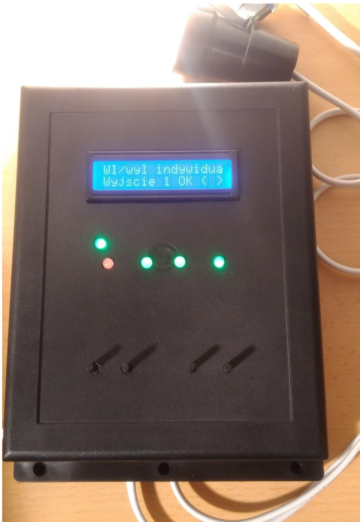
Rysunek 4.17. Zdjęcie przedstawiające wyłączony jeden z kanałów kontrolera
