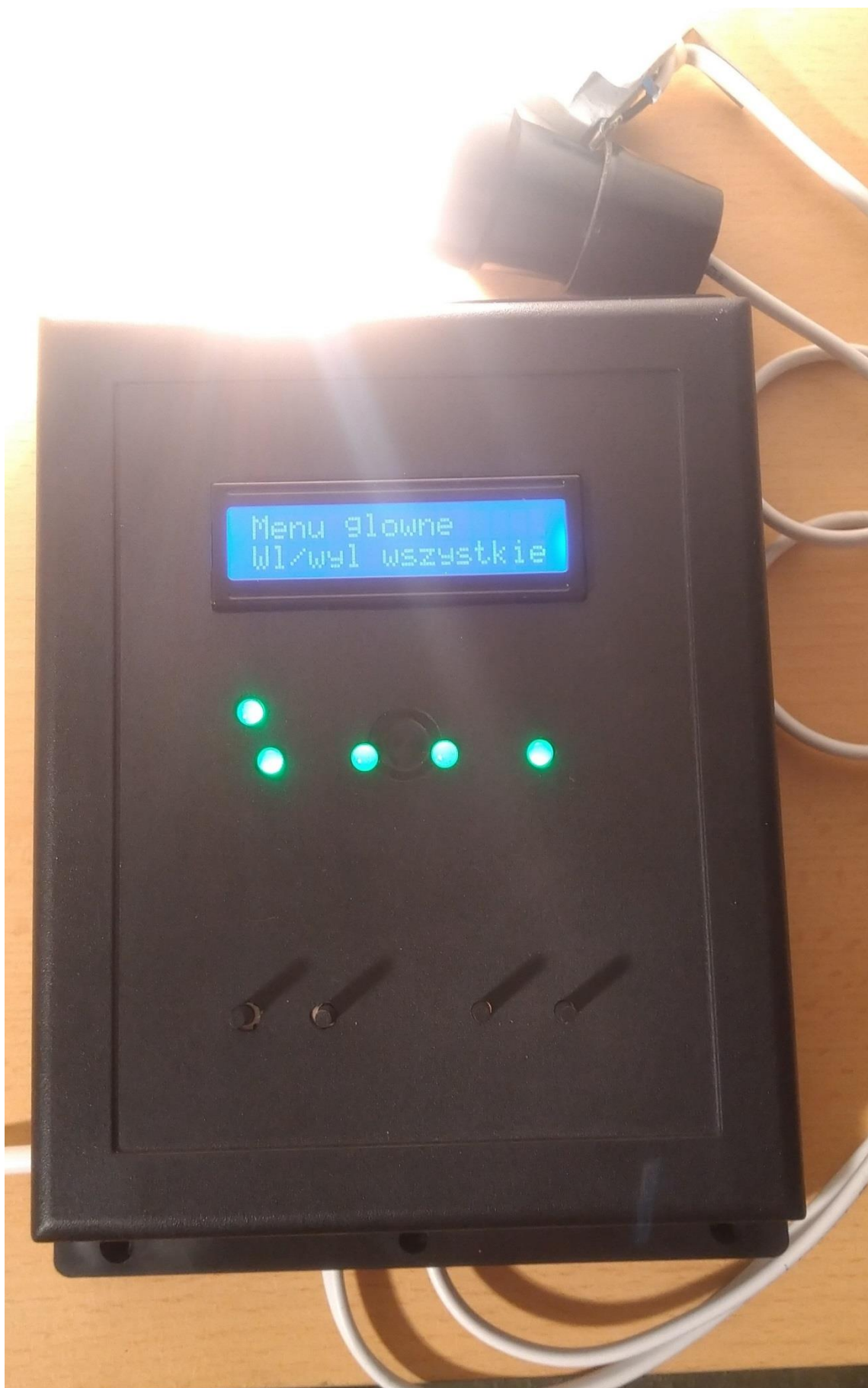
Rysunek 4.16. Zdjęcie przedstawiające kontroler z układem testowym po włączeniu wszystkich wyjść z poziomu menu LCD kontrolera
