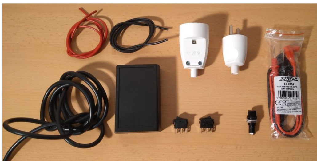
Rysunek 4.21. Zdjęcie przedstawiające elementy wykorzystane do konstrukcji przyrządu do pomiaru przepływu prądu czuwania urządzeń jednofazowych
