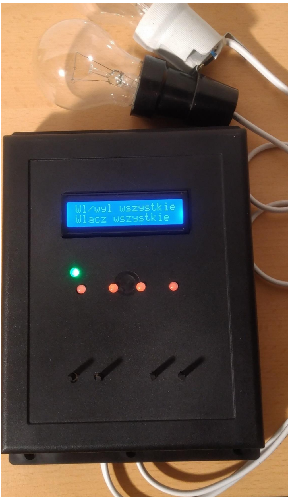
Rysunek 4.15. Zdjęcie przedstawiające kontroler z układem testowym po wyłączeniu wszystkich wyjść przy pomocy menu LCD kontrolera
