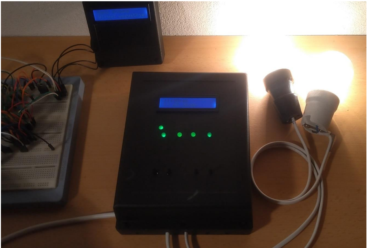
Rysunek 4.14. Zdjęcie przedstawiające działające oba urządzenia składające się na system poprawnie kominukujące się wraz z przykładowym obciążeniem wyjść kontrolera
